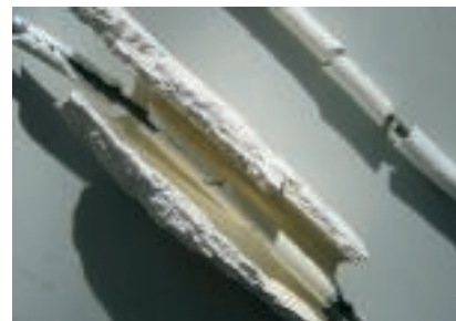
Огнестойкий кабель с изолирующим слоем золы
